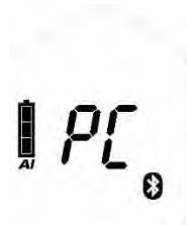
Nawiązanie połączenia z urządzeniem przenośnym
